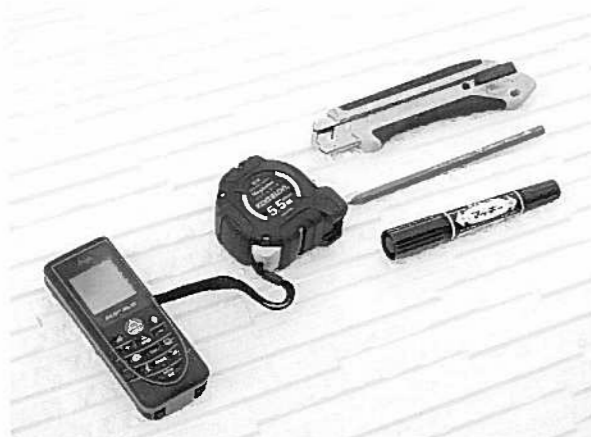
REG が現場で使っている採寸道具類。レーザー測定器だけでなく、メジャーなども使う。
